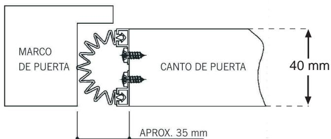
Cuando resulte necesario, nuestro sistema antipillados permite proteger la parte de la cerradura, recortando la puerta aproximadamente 35 mm con una altura mínima de 1,10 m.
