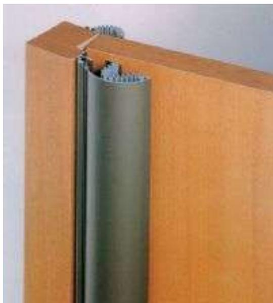
En el lado de la hoja la protección está asegurada por una tapa articulada sobre un perfil bisagra unido a la puerta por una junta de seguridad tipo acordeón. Cuando la puerta se cierra, la tapa se apoya sobre la puerta y oculta la junta.
